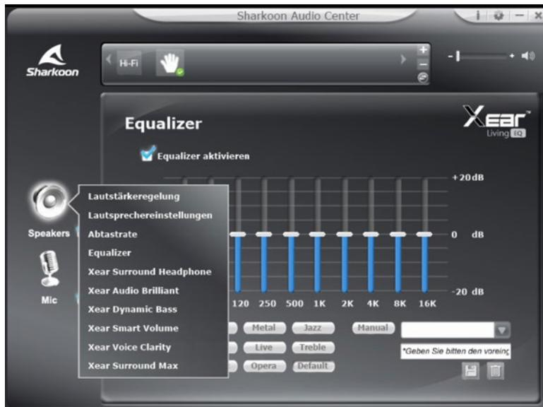
Mit dem Sharkoon Audio Center können Sie die Lautstärke der Lautsprecher des B2 regeln, über den Equalizer Änderungen am Klang vornehmen, auf eine Vielzahl an vorinstallierten Effekten zugreifen sowie die simulierte Position des 7.1-Surround-Sound konfigurieren. Um auf die einzelnen Menü-Punkte zugreifen zu können, klicken Sie mit Rechtsklick auf das Lautsprecher-Symbol an der linken Seite der Software.
