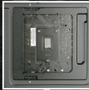
CPU coolers 背板快速安裝孔位
